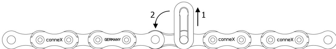
4. Biegen der Kette bis die Bohrung der Verschlusslasche über den Bolzen gleiten kann.
