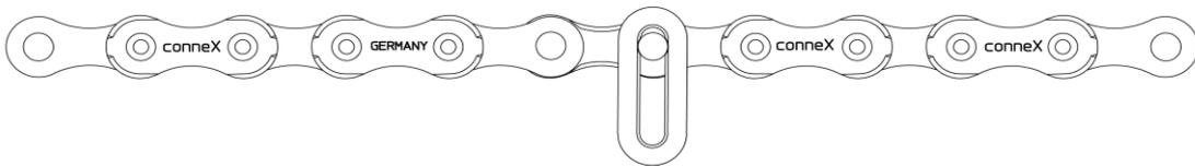
3. Die Lasche bis an den Endpunkt der Nut schieben (1) und 90° (2) verdrehen bis die Bohrung über dem Bolzen liegt.
