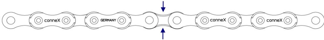
2. Die beiliegende Lasche mit der Bohrung auf einen der Bolzen setzen.
